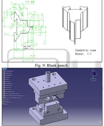
Fig. 10: Bending die assembly
